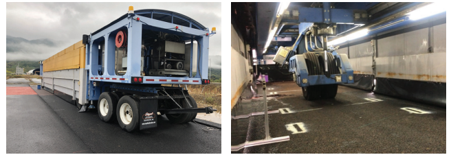
도로인프라 국가성능시험장의 포장가속시험기를 이용한 포장 장기공용성 시험
