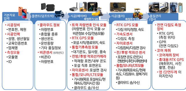
그림 2. IoT 기반 아스팔트 포장 품질관리 기본 계획
