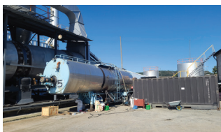
그림 3. 이동식 교반과 가열 및 보온탱크
