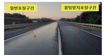
그림 7. 도로 살얼음 모사 시험 후 포장 전경
